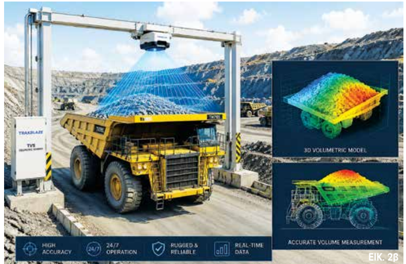
ΕΙΚΟΝΑ 2: Χρήση τεχνητής νοημοσύνης για τον υπολογισμό της κοκκομετρίας στο σωρό ανατίναξης (α, Vu et al., 2021) και κατά τη διάρκεια μεταφοράς του υλικού (β).
